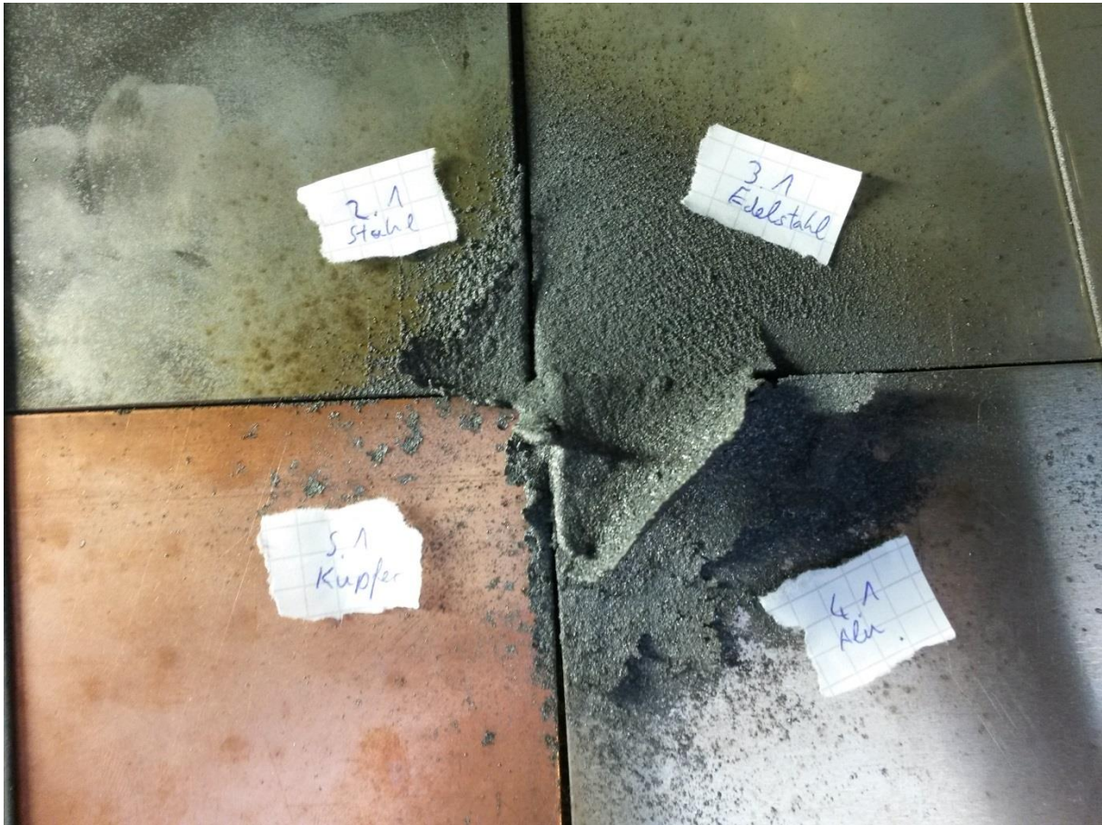
Abbildung 6: Detailansicht der anhaftenden Schlacke auf den Probeblechen [1]
