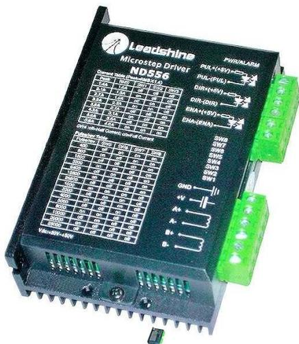
Phasenstrom von 1,4 bis 5,6A (peak) in 8 Schritten per Dip-Schalter einstellbar
