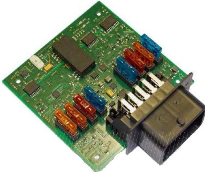
Als Steuergerät für den Testaufbau habe ich mich für ein selbstentwickeltes Steuergerät entschieden, die Aufgaben der oben abgebildeten PDU (Power Distribution Unit) bestehen im Testaufbau darin als Empfänger und Sender von CAN-Nachrichten, auf Eingaben zu reagieren und den momentan Stromverbrauch an die Basisstation zurückzugeben.
