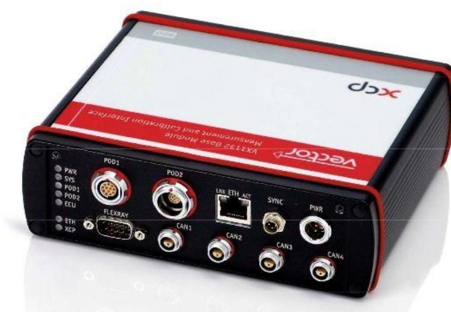
Die von Vector zur Verfügung gestellte Hardware bietet, wie man auf der Abbildung erkennen kann, einige Möglichkeiten sich mit Steuergeräten zu verbinden und sogar ganze Kommunikationsnetzwerke abzudecken.
