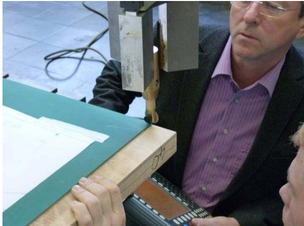
Bild Nr.1: Festlegung des Bezugskoordinatensystems
