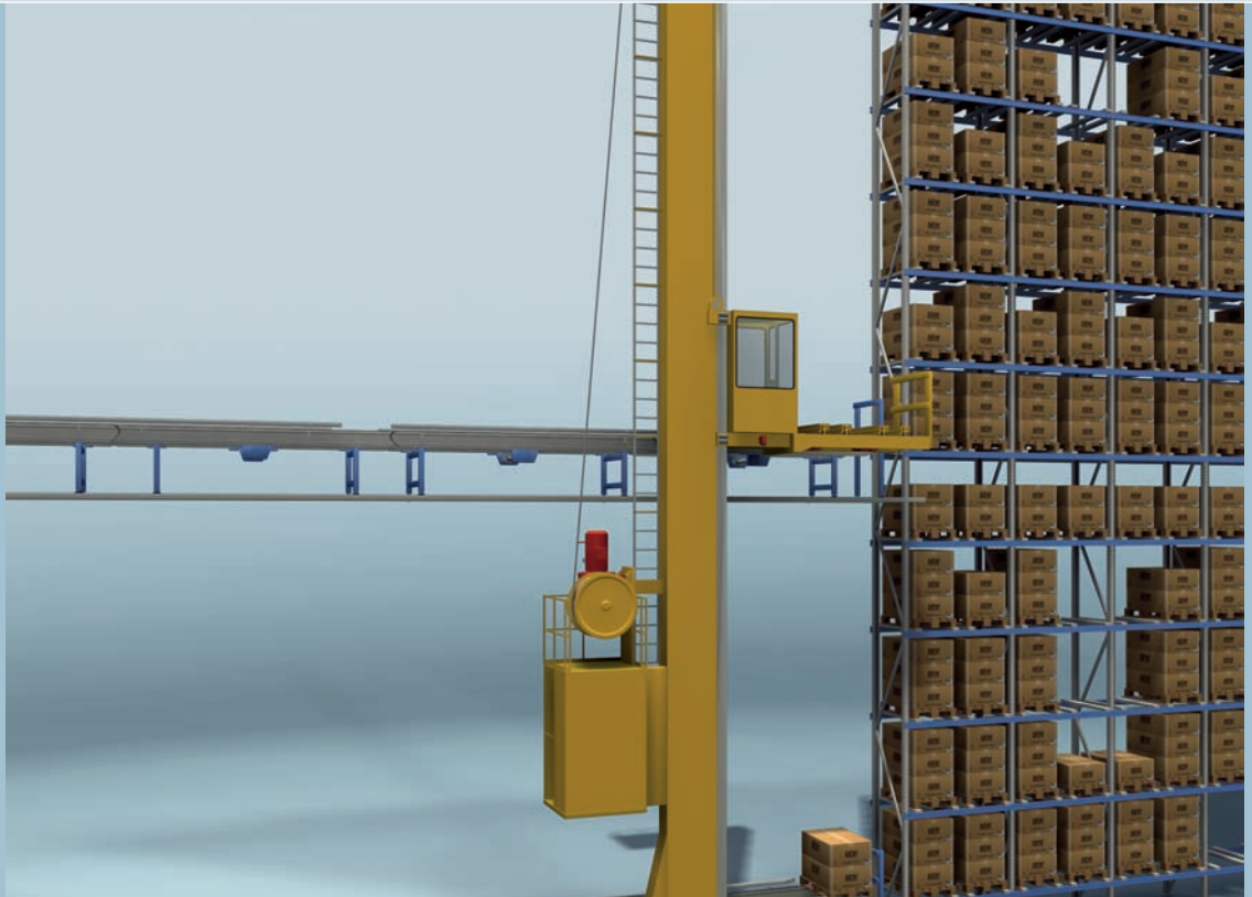
Regalbediengerät (RBG), am Beispiel eines Hochregallagers in der Lagerlogistik
